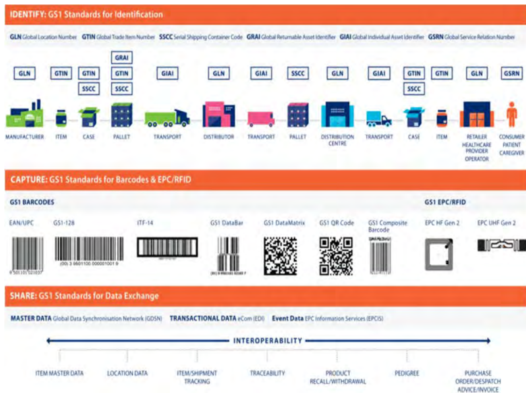
図2 サプライチェーンプロセスとGS1標準の体系
